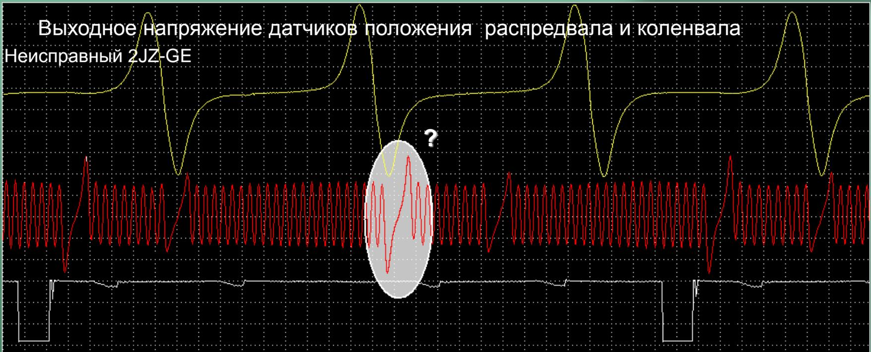
Выходное напряжение датчиков положения распредвала и коленвала
