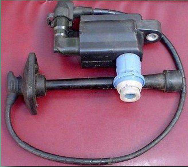
“...1. На этом двигателе (фактически Мицубиши) имеется программная недоработка (которая на следующих машинах была устранена производителем) когда при отключении датчика коленвала искра подавалась на одну катушку (из двух)...”
