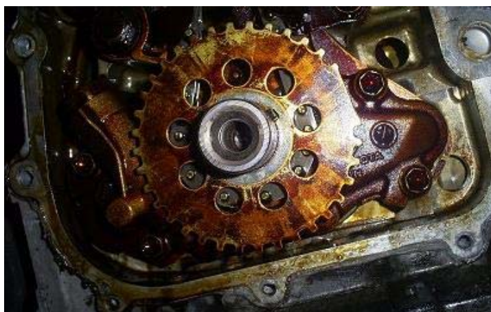
Неправильная установка диска датчика (Рис.06.)
