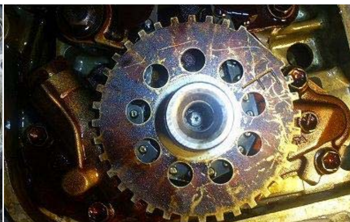
Маркерный диск установлен правильно (Рис.07.)
