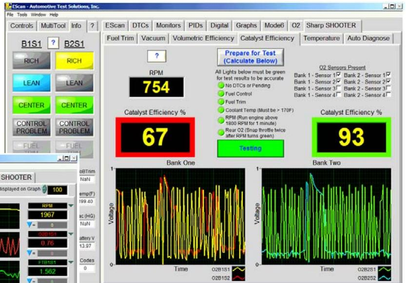
преобразователей, систем управления подачей топлива, систем подзарядки и другие. Сканер EScan поддерживает диагностику с использованием ISO-9141-2, KWP2000, J1850 (PWM and VPM) и CAN протоколов обмена данными и подключается через обычный последовательный порт персонального компьютера или ноутбука.
