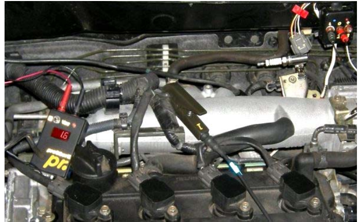
Подключение датчика разрежения и другой вариант подключения индуктивного датчика синхронизации
