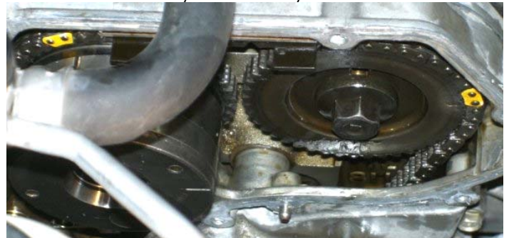
«Метки» после перестановки обоих валов «вперед на один зуб (слева видна муфта переменного газораспределения)
