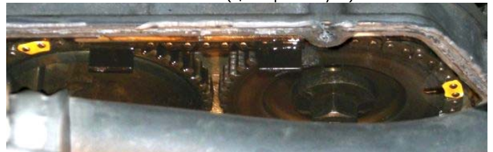
«Метки» ГРМ впускного и выпускного коленвалов
