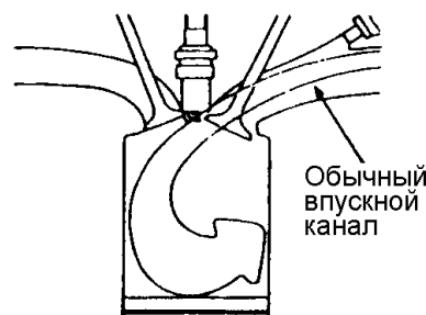
Рис. ТТ9-3 Обычный двигатель с распределенным впрыском топлива (MPI)
