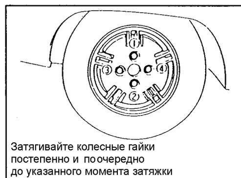
Затягивайте колесные гайки постепенно и поочередно до указанного момента затяжки
