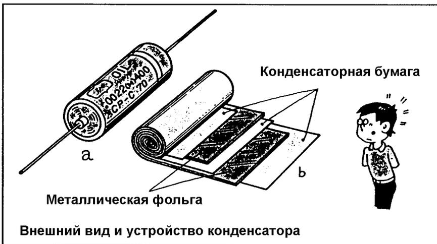
Внешний вид и устройство конденсатора
