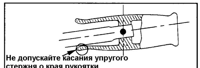
Рис. 3-26 Неправильный способ работы динамометрическим ключом
