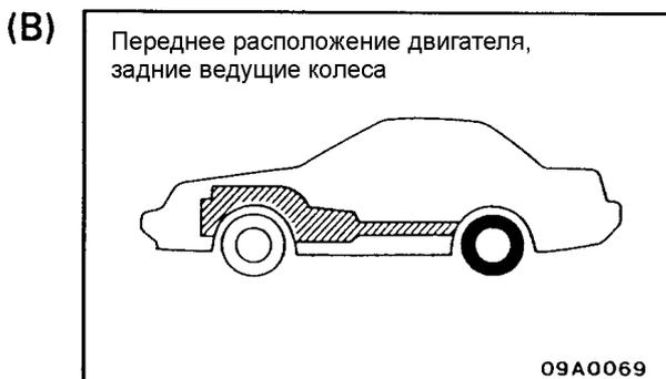
Большая часть коммерческих автомобилей, производимых фирмой Mitsubishi: L-200-2WD (заднеприводная модель), L300-2WD (заднеприводная модель) и др.
