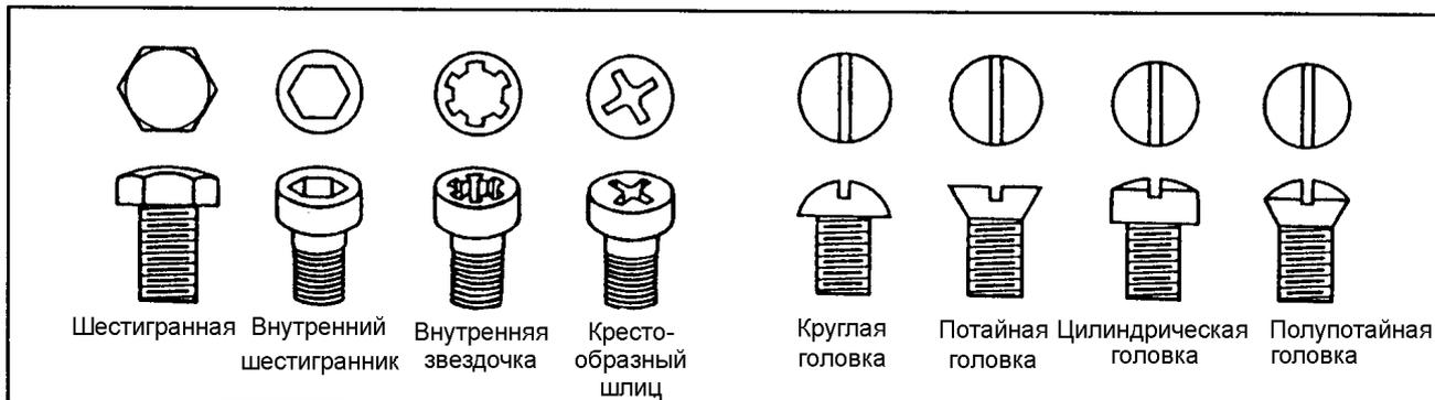
Рис. 4-3 Различные типы головок винтов
