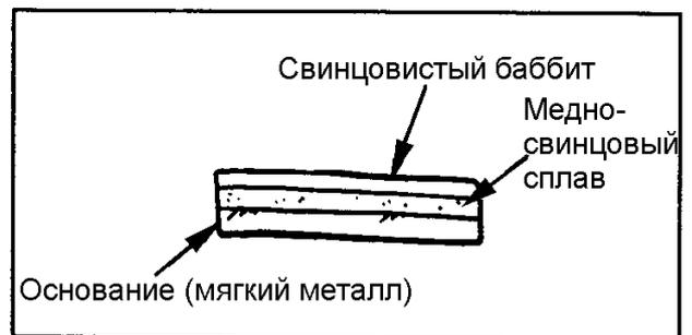
Рис. 7-38 Триметаллический вкладыш
