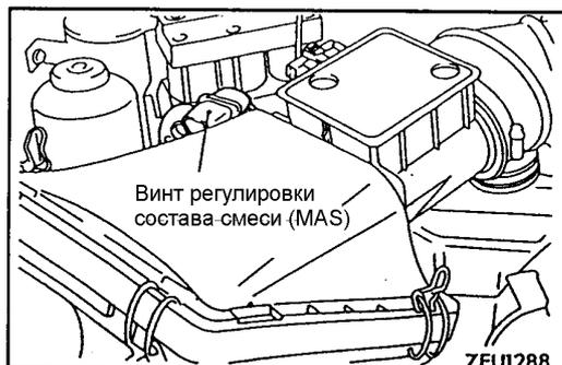
Рис. 10-63 Отрегулируйте состав топливоздушной смеси
