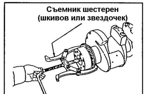
Рис. 2-28 Как использовать съемник шестерен
