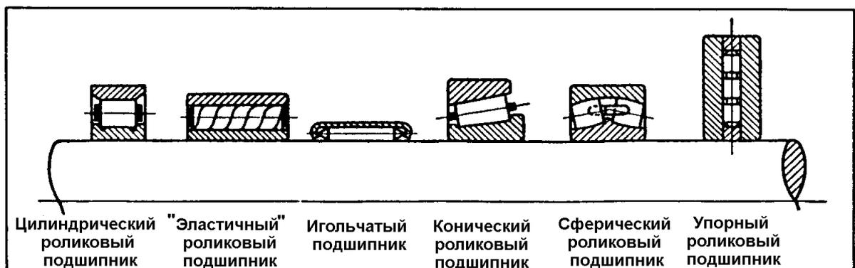
Рис. 4-27 Роликовые подшипники
