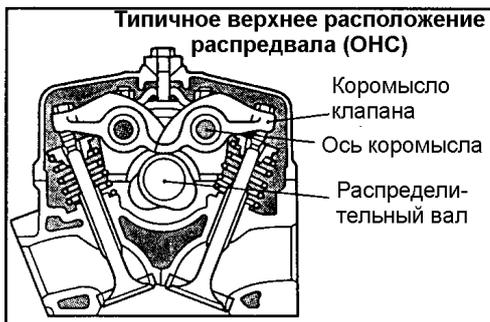
Рис. 6-10 Один верхний распределительный вал (ОНС)
