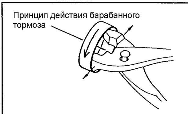
Рис. 20-1 Барабанный тормоз
