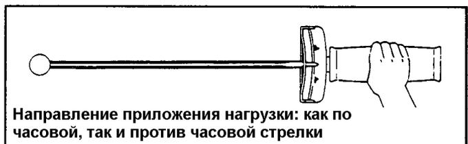
Рис. 3-25 Правильный захват рукоятки динамометрического ключа
