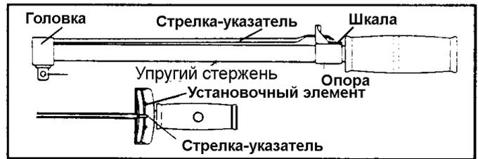
Рис. 3-21 Динамометрический ключ стрелочного типа (с упругим стержнем)
