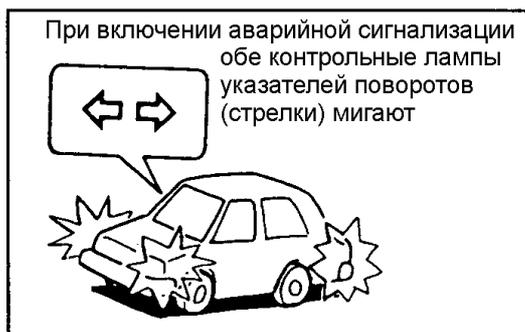
Рис. 25-7 Аварийная сигнализация
