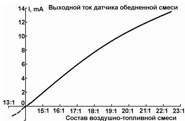
Рис. 3. Зависимость тока датчика от степени обеднения смеси
