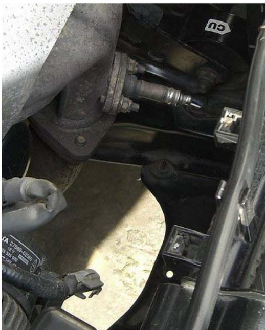
Как вы помните, обычный кислородный датчик характеризуется наличием двух устойчивых состояний. При обогащенной смеси он вырабатывает повышенное напряжение, а при избытке кислорода – пониженное. Эта «переключательность» приводит к тому, что блок управления (БУ) не в состоянии определить точный состав смеси и необходимую в данный момент степень её изменения.
