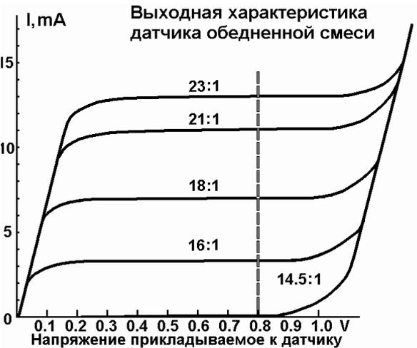
5. Выходная характеристика датчика обедненной смеси при разном составе смеси
