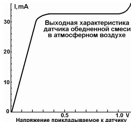
**Рис. 4. Выходная характеристика датчика в атмосферном воздухе**
