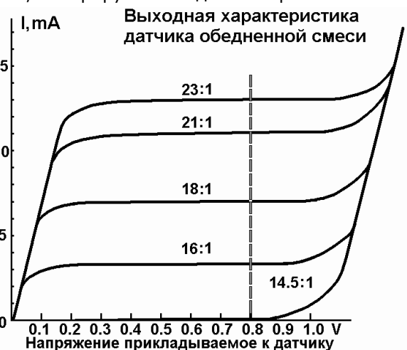
5. Выходная характеристика датчика обедненной смеси при разном составе смеси
