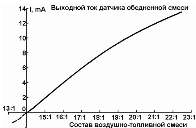
**Рис. 3. Зависимость тока датчика от степени обеднения смеси**
