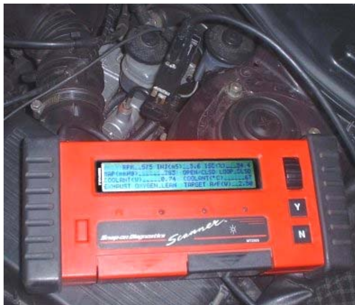
Фото 2. Проверка «Target A/F» системы с pre-OBDII
