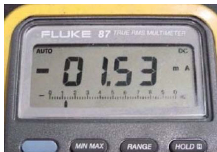
Ток датчика при обогащенной смеси
