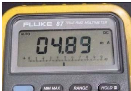
Ток датчика при обедненной смеси
