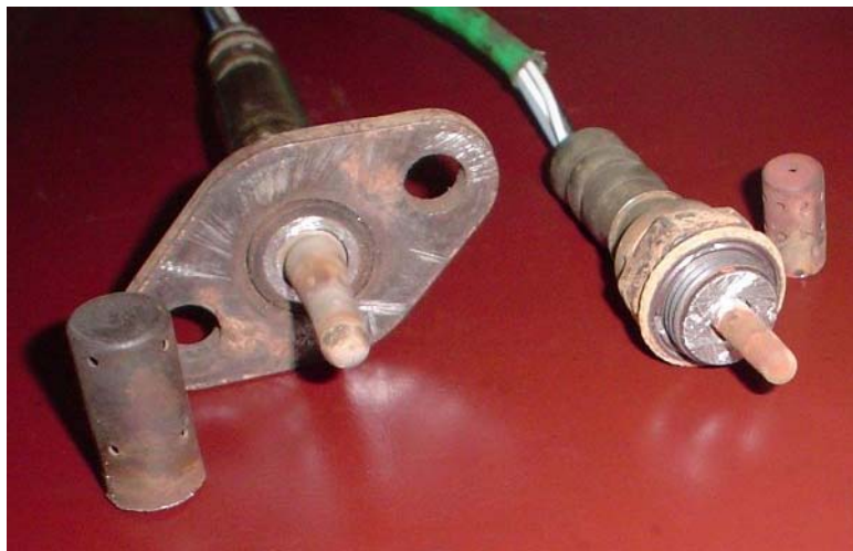
Способы крепления и внешний вид чувствительного элемента датчиков первого поколения
