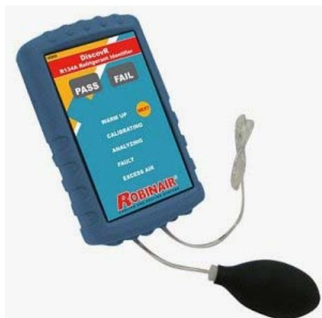
кондиционирования конкретного автомобиля. Каждый техник обслуживающий автомобильные системы кондиционирования знает, что детали и узлы этой системы не позволяют использовать разных типов «носителей холода». Поэтому для избегания их поломки и последующего дорогостоящего ремонта необходимо перед заправкой убедиться в том, что в системе находится совместимое «рабочее вещество».
